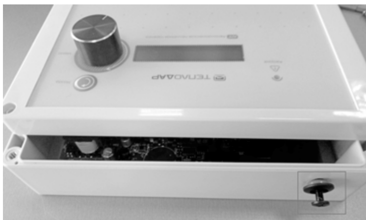
Рис. 6. Удаление заглушки из отверстия для антенны
